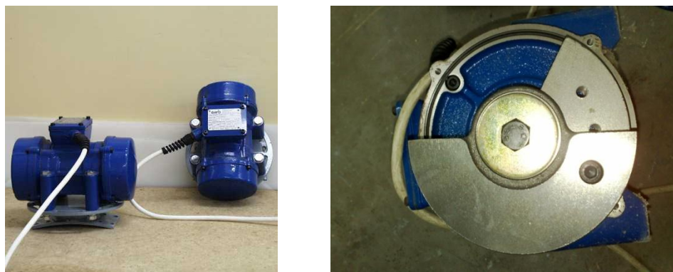
Rys. 6. Wibratory elektryczne rotacyjne, sposób regulacji sił Fig. 6. Electric rotary vibrators, method of force regulation
