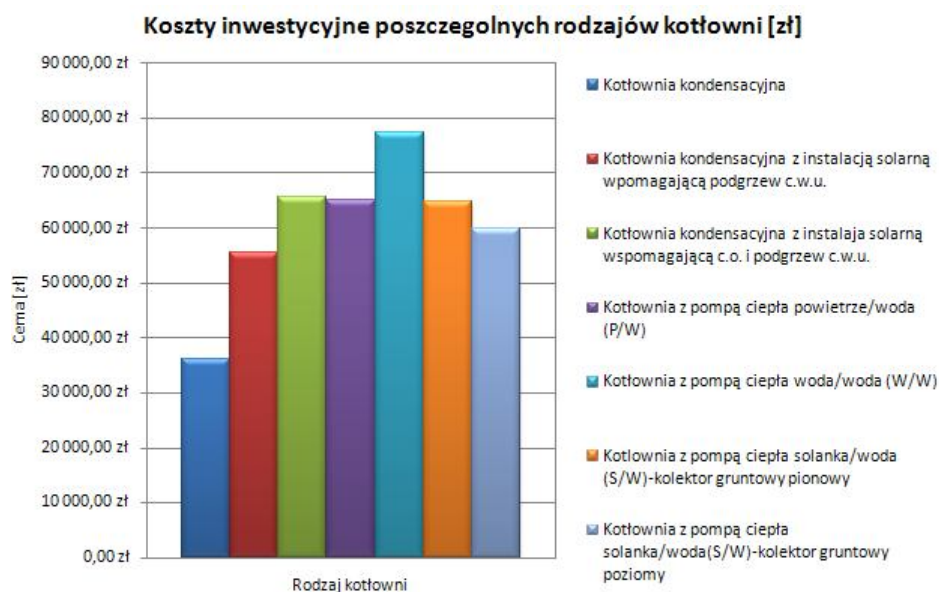
Rys. 7. Porównanie nakładów inwestycyjnych poszczególnych rodzajów kotłowni
