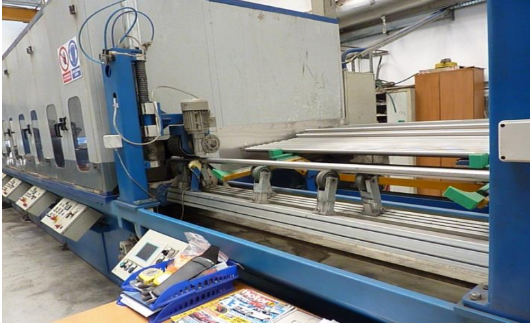
Rys. 3. Widok linii szlifierskiej do obróbki rur Fig. 3. View of the grinding line for pipe processing
