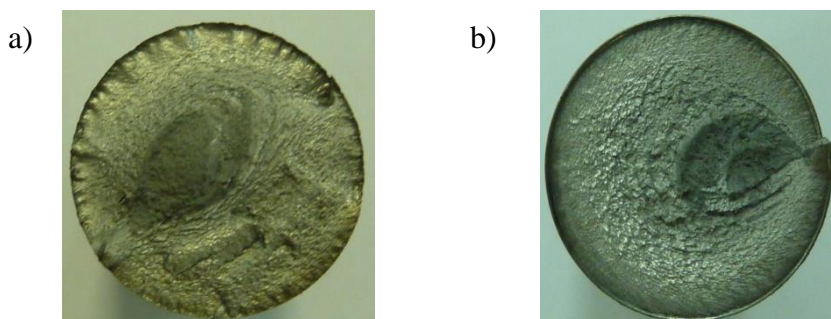
Rys. 9. Widok złomu zmęczeniowego próbek: a) po toczeniu, b) po nagniataniu Fig. 9. View of the fatigue scrap metal of the samples: a) after turning, b) after burnishing
